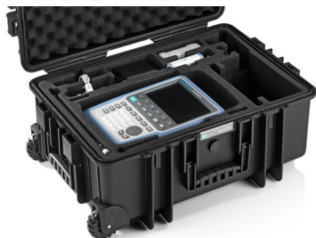
Анализатор R&S®Spectrum Rider FPH в жестком кейсе R&S®HA-Z231
